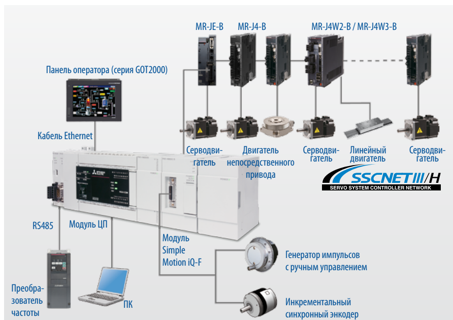
Структура конфигурации системы, включающей сервоприводы и серводвигатели с ПЛК-ЦП MELSEC iQ-F.
