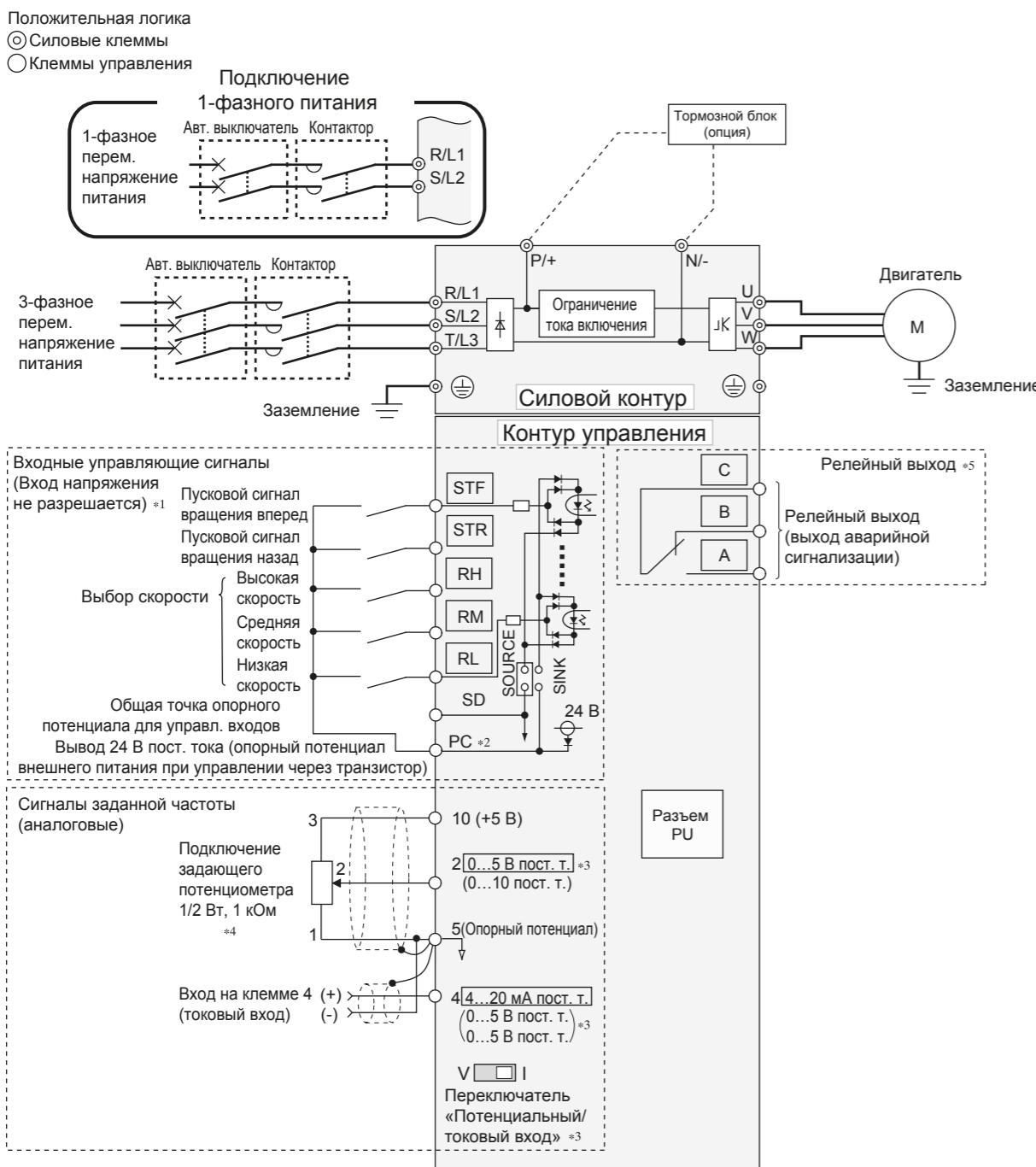
\*1 Сигнал, присвоенный этим клеммам, можно изменить на сигнал сброса или другой тип сигнала с помощью функции определения назначения входных клемм **(пар. с 178 по 182)**.
