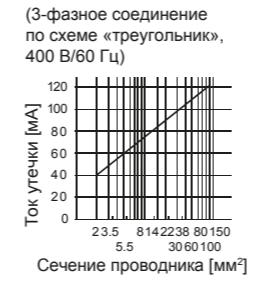
При подключении по схеме «звезда» ( $\Delta$ ) ток утечки составляет прибл. 1/3 от вышеуказанных значений.
