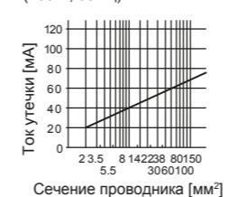
Пример тока утечки на каждый километр длины проводки при непосредственном питании от сети и прокладывании кабеля, изготовленного методом непрерывной вулканизации (CV), в металлическом кабельном канале (200 В, 60 Гц)
